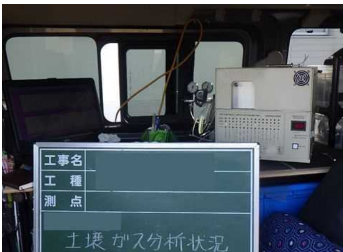
現地土壌ガス分析（車内）
