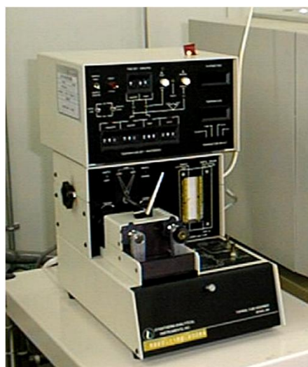
熱脱離装置(TDU)。固体捕集管を300℃に急速加熱して捕集成分を脱離させ、その全量を直接GCに導入させる。
