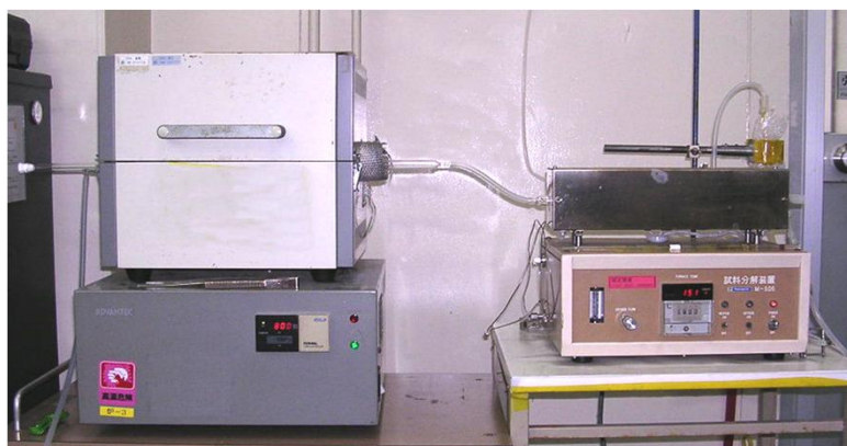
加熱用電気炉。図のような二連加熱も可能。前段（右）で試料を200℃に加熱し、発生したガスを後段（左）で800℃で再加熱させる例。
